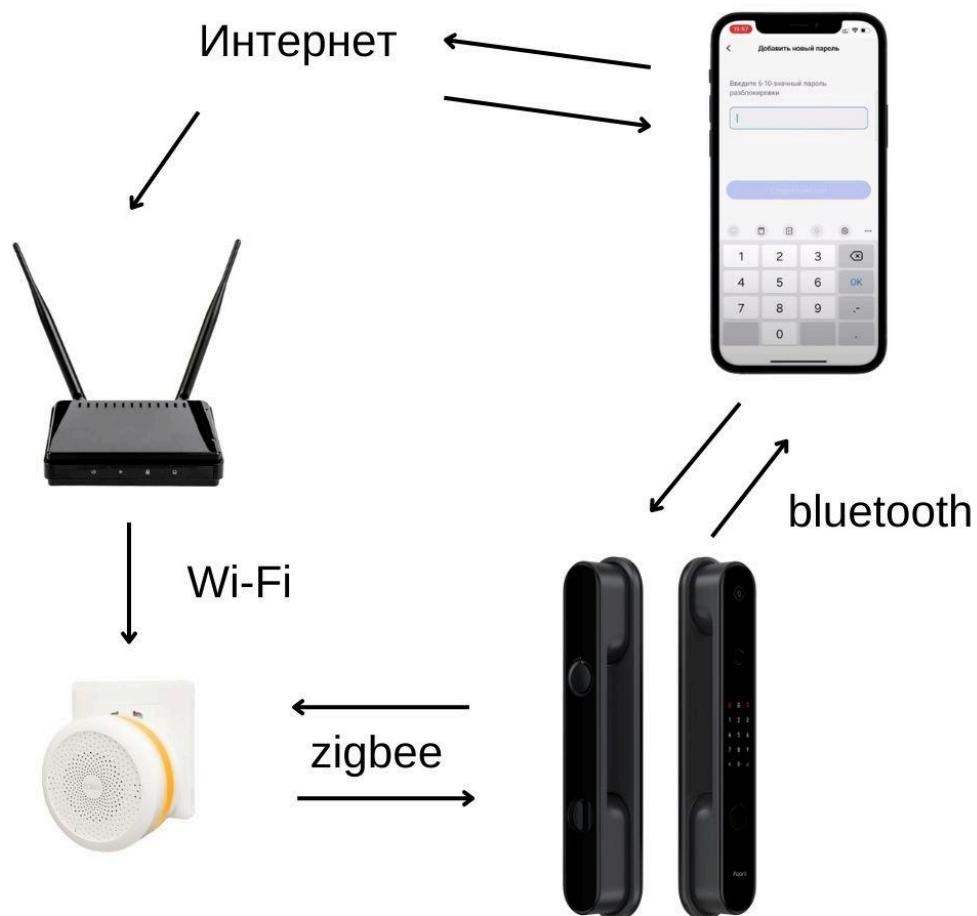
С хабом замок соединяется по Zigbee, с смартфоном замок соединяется по Bluetooth.
