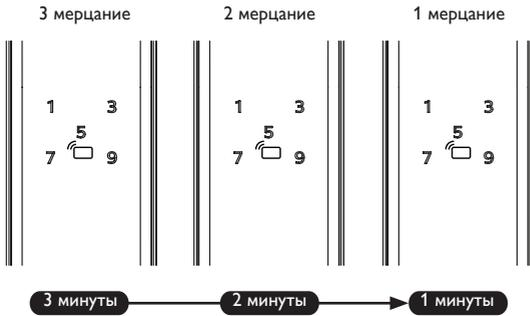
При 5 последовательных неверных вводах любого из 3-х методов проверки (отпечаток пальца / PIN-код / карта) система будет заблокирована на 3 минуты.
