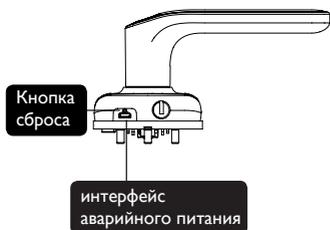
Когда заряда батареи недостаточно и дверцу невозможно открыть снаружи, вы можете включить замок через интерфейс Micro USB, используя блок питания 5V в качестве источника аварийного питания. После открытия дверного замка немедленно замените батареи. В случае сбоя системы и невозможности открыть дверь снаружи, нажмите кнопку [RES], а затем отпустите ее для автоматической перезагрузки.
