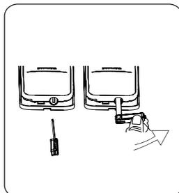
② Вставьте ключ в замочную скважину и держите ключ и корпус ключа вертикально друг к другу. Поверните корпус ключа по направлению к ручке на  $90^\circ$ , пока он не упрется в поверхность двери.
